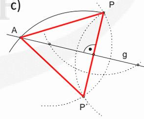
P spiegeln an g; Kreis um P bzw.  $P'$  mit  $r = |PP'|$  schneidet g in A und B.
